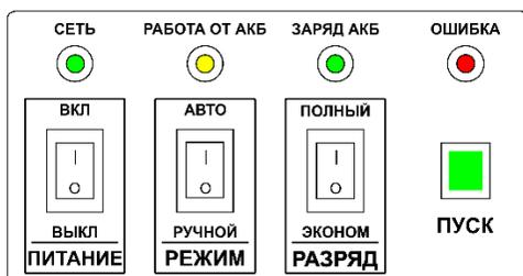
Рисунок 1. Панель управления и индикации
