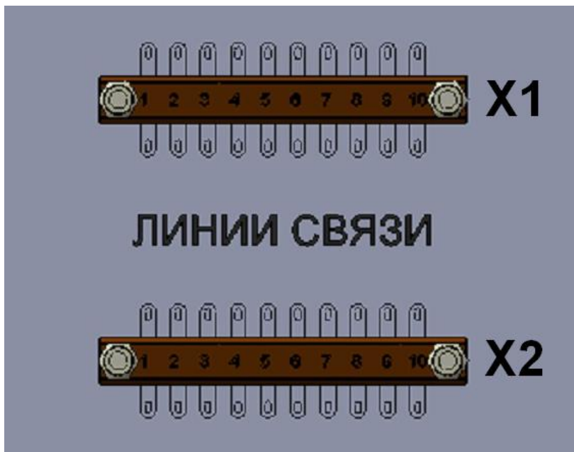
Рис. 7. Колодки для подключения линий связи.
