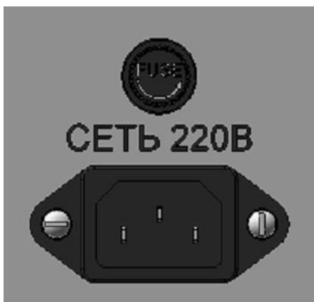
Рис. 3. Разъем питания и держатель предохранителя.
